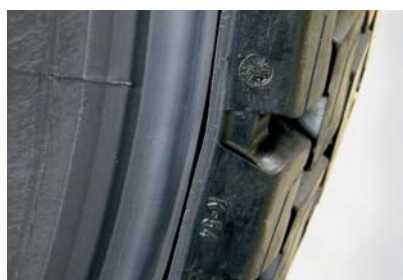
Der perfekte Übergang von aufgebauter Schulter auf die gewünschte Laufstreifenbreite ist exakt einstellbar.
