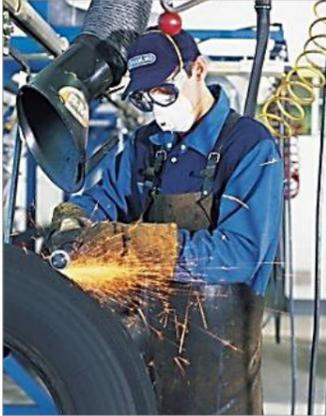
Vorbereitung der Karkasse (Schleifen, Füllen, Lösungsauftrag,...) - Lösungsauftrag auch auf die Seitenwand
